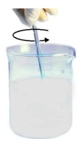
Remueva enérgicamente la mezcla durante varios minutos hasta que los dos componentes se hayan integrado completamente
